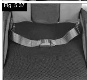
Der Beckengurt ist wie abgebildet am Rollstuhl angebracht. Der Gurt besteht aus 2 Hälften. Diese werden mit der Befestigungsschraube für die Haltestange befestigt, die durch die Öse am Gurt gesteckt wird. Der Gurt wird unter der Rückseite des Seitenteils entlang geführt. (Fig. 5.36)
