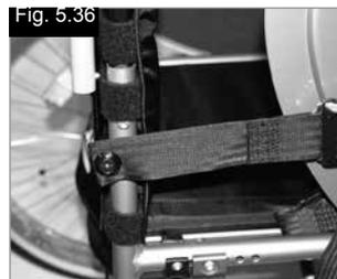
Achten Sie immer darauf, dass der Beckengurt vor dem Gebrauch des Rollstuhls korrekt angebracht und eingestellt ist. Wenn der Gurt zu locker sitzt, kann der Benutzer nach unten rutschen und es besteht Erstickungsgefahr oder es kann zu schweren Verletzungen kommen.
