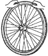
Wenn der Schlauch ohne Falten in den Reifen passt (bei Falten: lassen Sie etwas Luft heraus), kann beginnend am Luftventil die Oberseite des Reifens mit beiden Händen leicht an die Felge gedrückt werden. Drücken Sie das Luftventil leicht nach innen und ziehen Sie es erneut heraus, um sicherzustellen, dass der Reifen richtig im Bereich des Luftventils positioniert ist.
