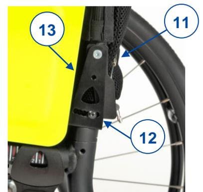
5. Überprüfen Sie die Position, indem Sie die Rückenlehne verschieben, bis sie mit den Sicherungsstiften einrastet. Stellen Sie sicher, dass beide Verriegelungsstifte in derselben Position gesichert sind.
